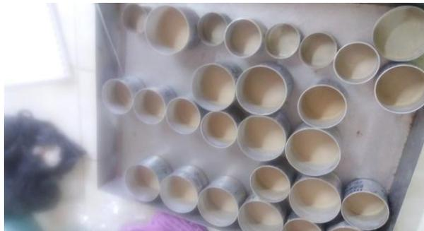
**Figura 79: Cápsulas usadas na secagem de sedimentos suspensos**
