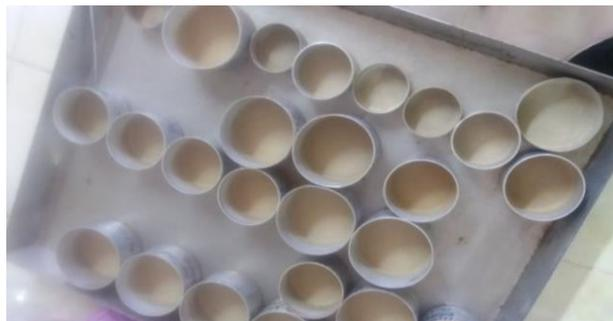
**Figura 5.** Cápsulas contendo amostras depois da secagem na estufa.
