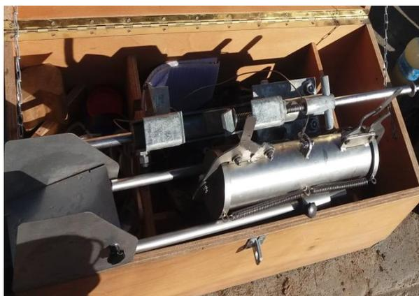
**Figura 4.** Watertrap, instrumento usado para colectada das amostras de sedimentos suspensos.
