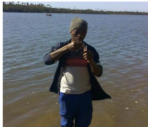
Figura 2- Diluição dos reagentes com a amostra de água
