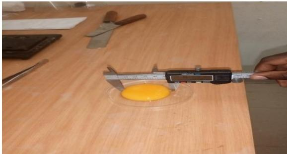
**Apêndice 9: de paquimetro digital MTX-316119 para medir o diametro da gema**
