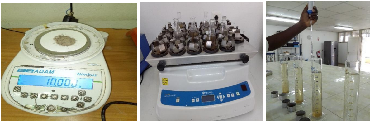
Figura 16: Certos equipamentos usados na determinação da granulometria do solo.
