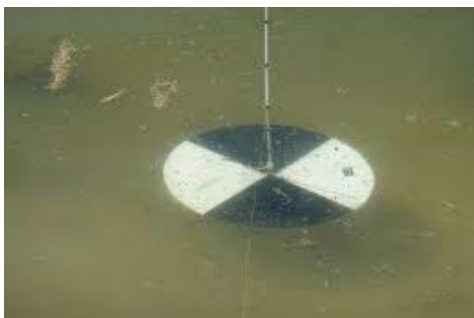
Figura 1: Instrumento usado para medir a transparência da água.
