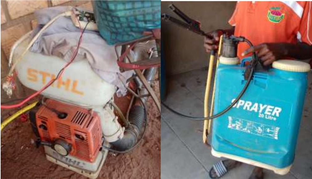
**Figura 5:** Atomizador e bomba manual para tratamento químico.
