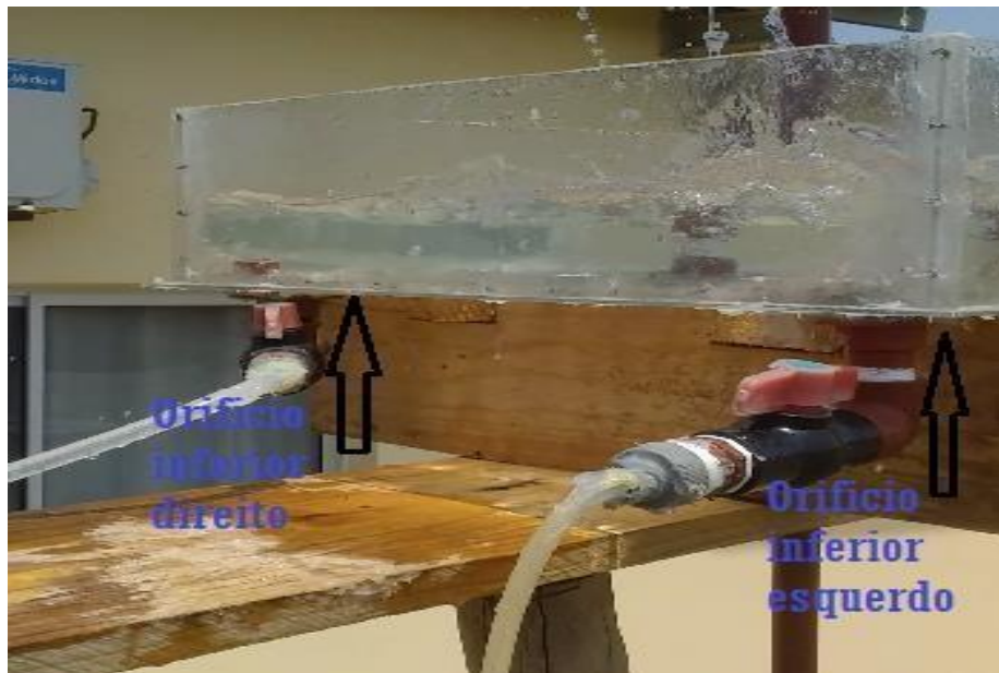
Figura 13: Orifício inferior esquerdo e direito no tanque de coleta de água aerada
