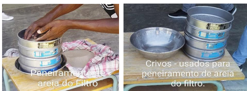
Figura 18: Peneiramento de areia usada filtro
