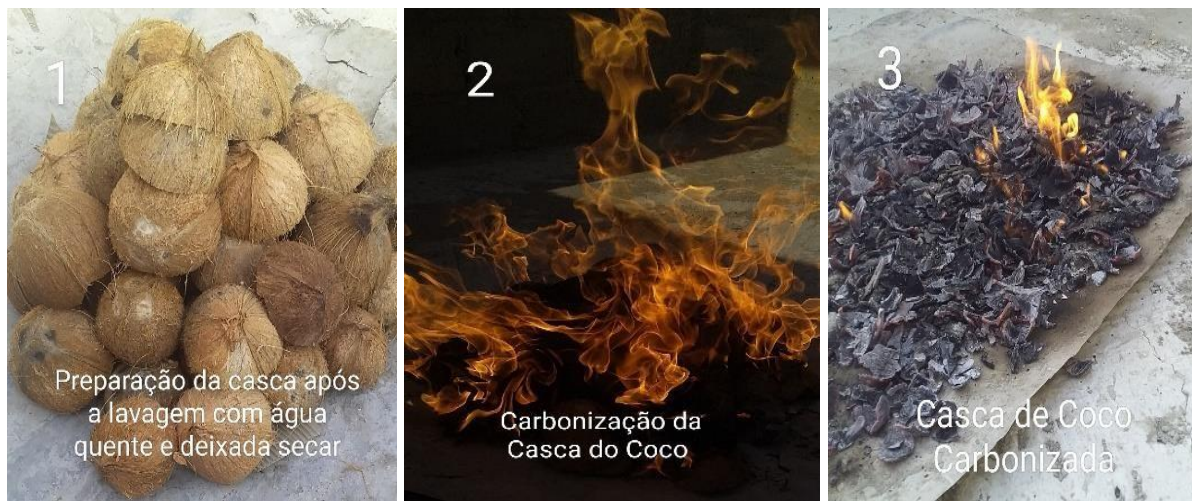
Figura 19: Processo de carbonização do endocarpo de coco
