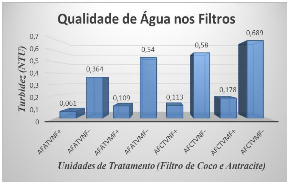
Figura 25: Valores médios das amostras de turbidez de água nas linhas de filtração
