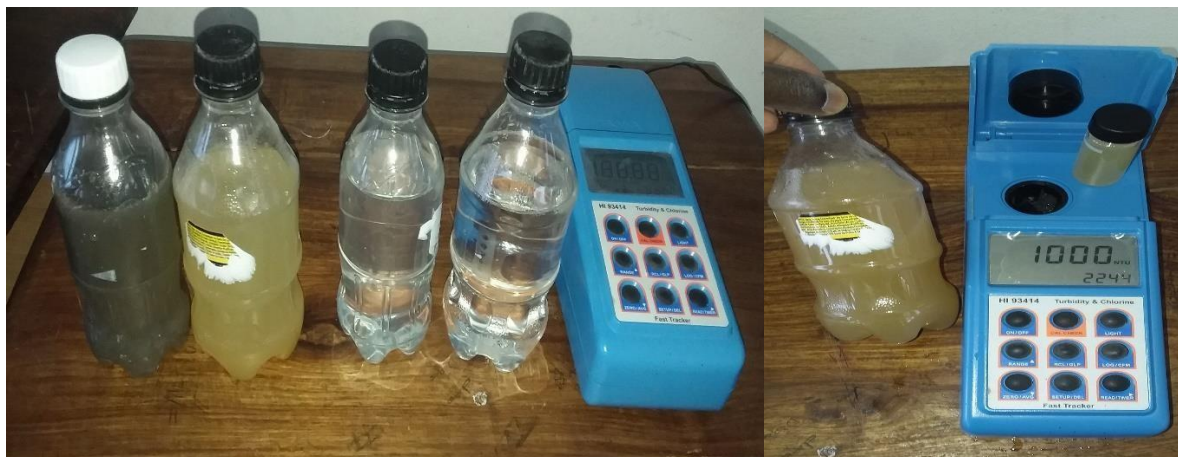
Figura 27: Processo de análise das amostras de água coletadas nas linhas de tratamento
