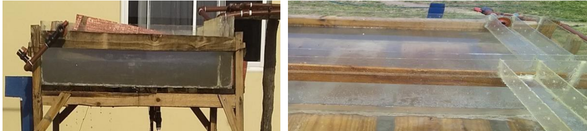
Figura 16: Dois decantadores instalados no sistema de tratamento de água para consumo humano
