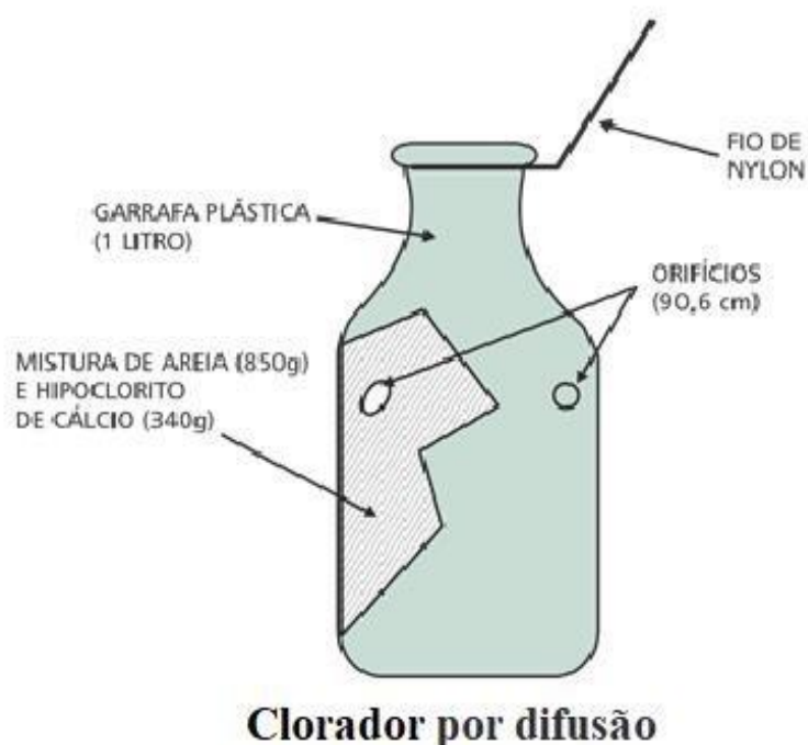
Figura 7: Clorador por difusão usado no processo de desinfecção da água
