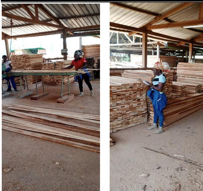
**Fig.7:** Topejamento    **Fig.8:** Cubicagem
