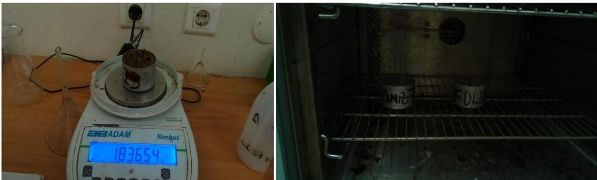
**Figura 7-** Procedimentos para determinação da Densidade
