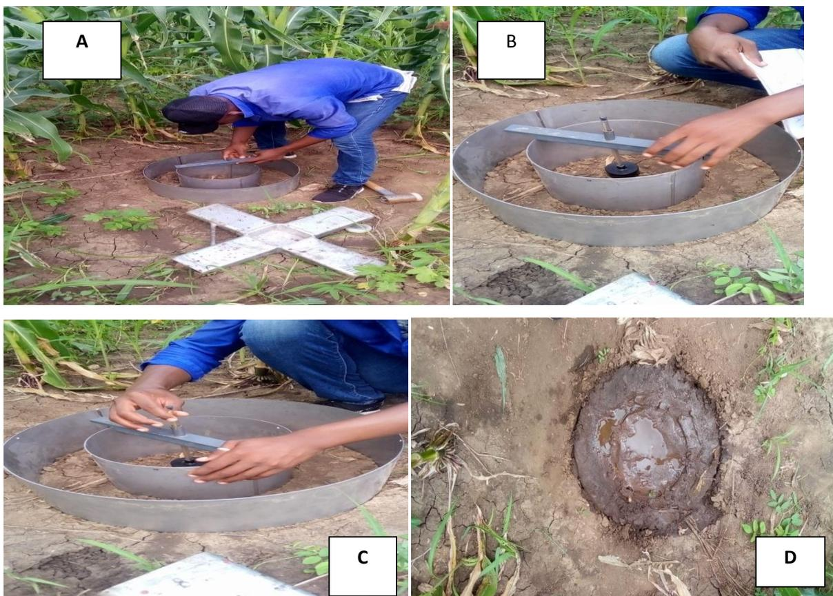
**Figura 8** -Infiltrômetro de duplo anel enterrado, cruzeta, régua e martelo mecânico.
