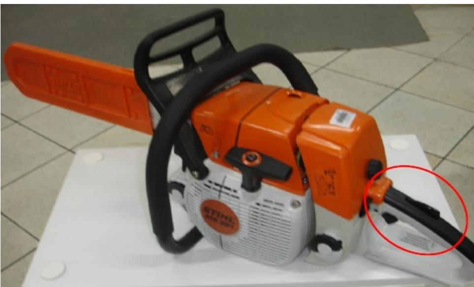
Figura 4: Trava de segurança do acelerador (indicado em vermelho).
