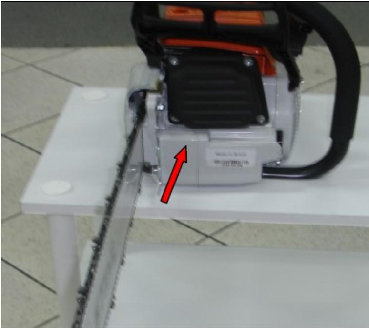
Figura 5: Silencioso e escapamento da motosserra (seta em vermelho).
