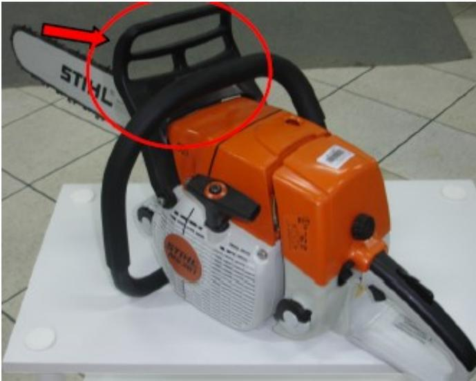
Figura 1: Freio manual da corrente (indicado em vermelho)
