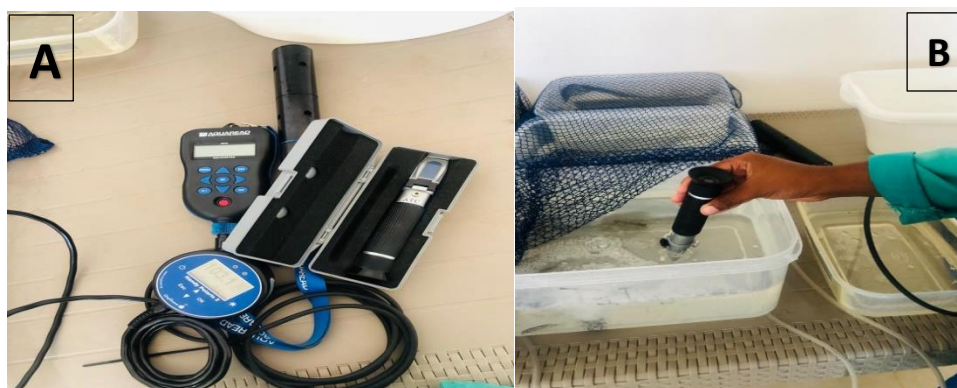
Figura 6: Multi-Parâmetro, oxímetro, o refratômetro portátil (A); Medição do nível de salinidade (B)
