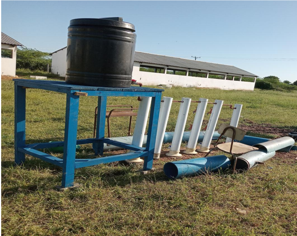
Figura 4: Imagem do sistema de tratamento de efluente de suinocultura instalado
