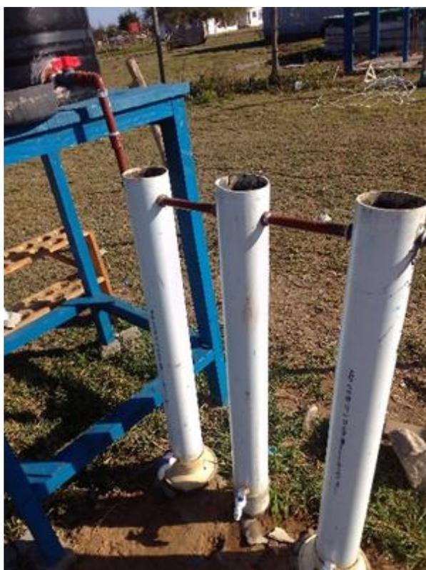
Figura 6: Vista geral do sistema de tanques sépticos
