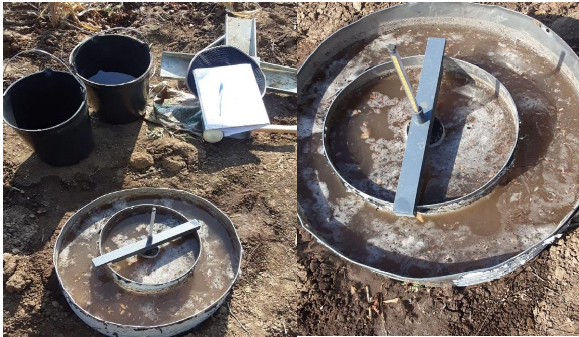
Figura 3 - Equipamentos de infiltração
