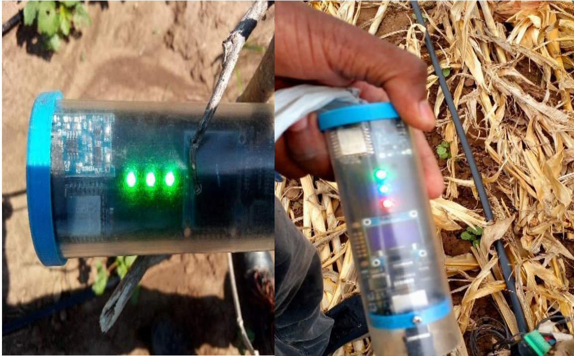
Figura 7 - Monitoramento da irrigação com base em sensores de humidade.
