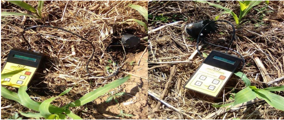
Figura.10: Representa o sensor que foi usado para determinar a humidade e a forma como foi executado no campo.
