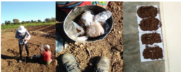
Figura 17: Representa de esquerda para direita a extracção das amostras para determinação da granulometria, amostras colocadas no balde e protegidas com saco plástico para o laboratório e por fim temos solo secando a temperatura ambiente após feita a mistura.
