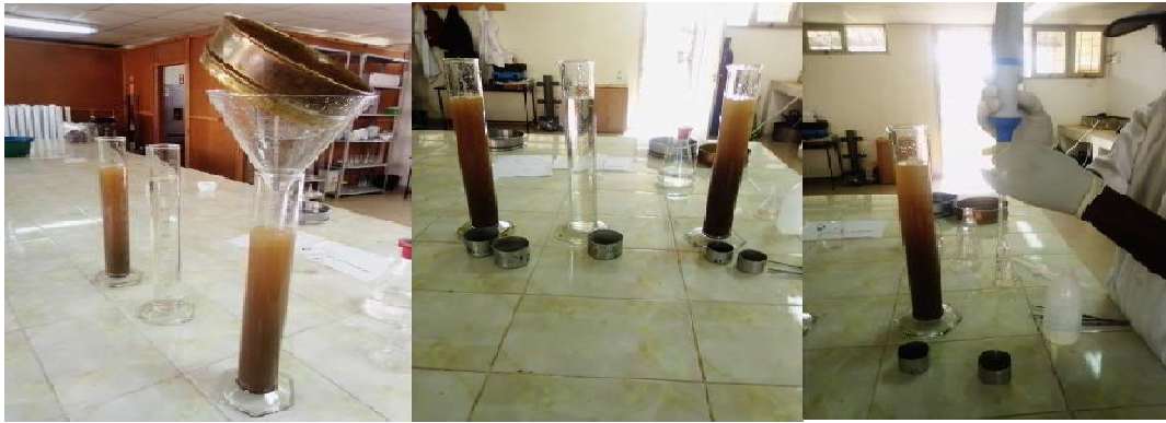
Figura 13: Da esquerda para direita estão representadas uma proveta contendo amostra após a agitação e o peneiro 0.053mm sobre um funil a separar-se areia do silte e argila; provetas contendo amostras após a separação da reia do silte e argila para o efeito da pipetagem a serem colocadas nos cadinhos que estão de lado de cada proveta e por fim temos o efeito da pipetagem da proveta para o cadinho.
