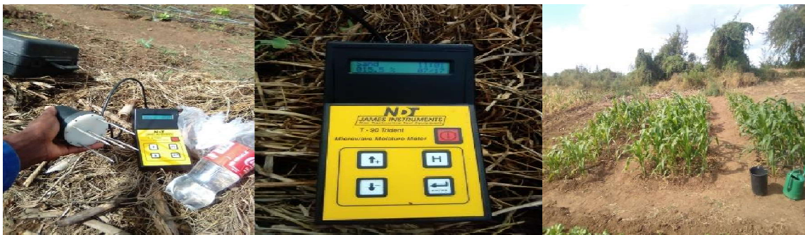
Figura 14: Representa um sensor de humidade utilizado nas leituras da humidade no campo e o respectivo campo onde foi executado o experimento.
