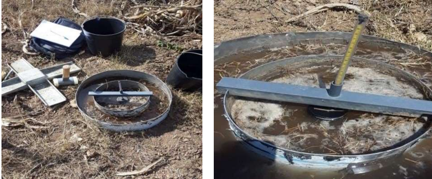
Figura 9: Representa anéis de infiltração cravados no solo para fazer leituras da velocidade de infiltração básica.
