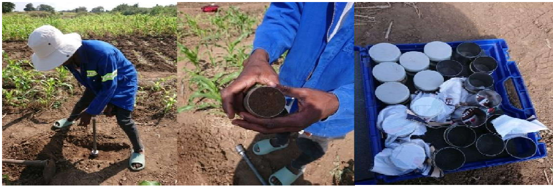
Figura 15: Da esquerda para direita representa como foram extraídas as amostras para a determinação da densidade do solo e a porosidade total, e o equipamento no qual foram transportadas as amostras de campo para o laboratório.
