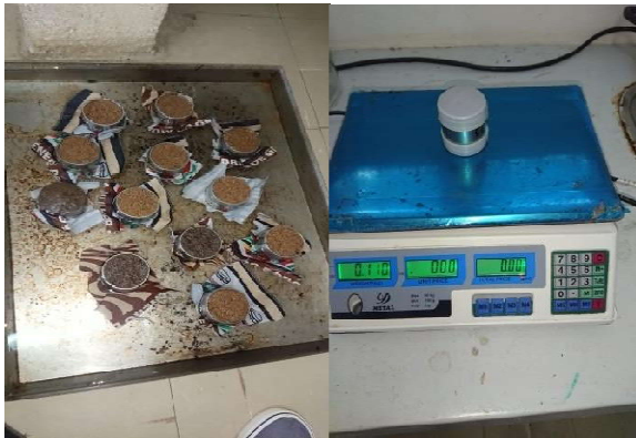
Figura 16: Representa amostras a serem saturadas para a determinação da porosidade e a balança utilizada para mensurar as amostras.
