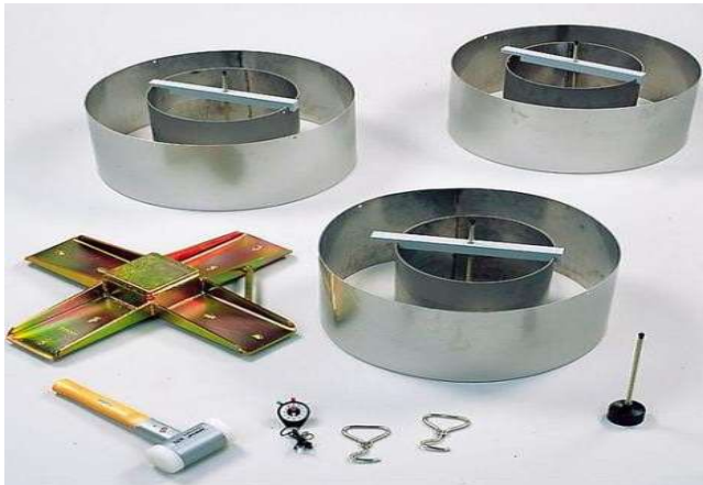
Figura 3: Anéis de Infiltração.
