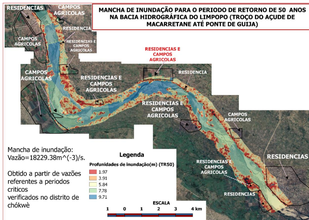
Figura 3: Mancha de inundação para tempo de retorno de 50 anos na Bacia hidrográfica do Limpopo (Troço Açude de Macarretane-Ponte de Guija). Fonte: (Autor, 2022)
