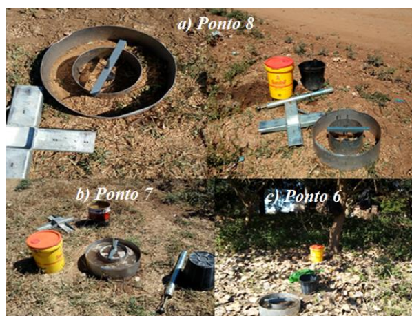
Figura 13: Ensaio de infiltração de água no solo. Fonte: (Autor, 2022).
