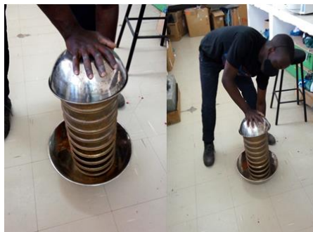
Figura 11: Peneiramento manual das amostras de solo. Fonte: (Autor,2022).
