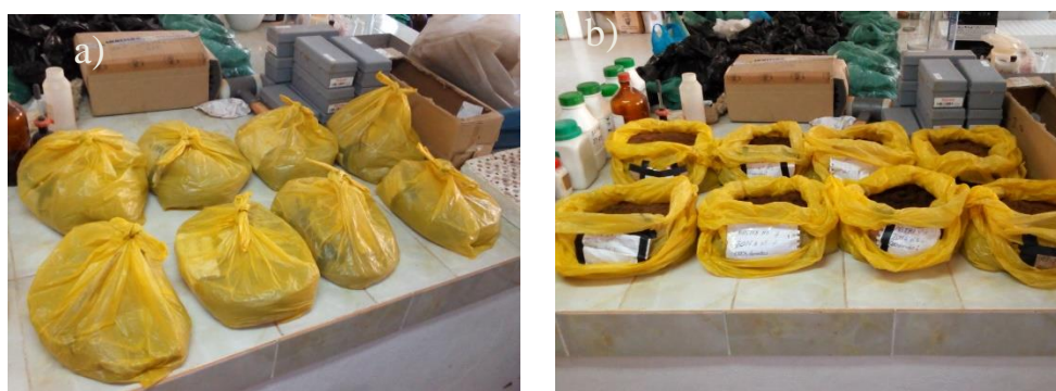
a)Chegadas das amostras ao laboratório b)Secagem das amostras ao ar livre
