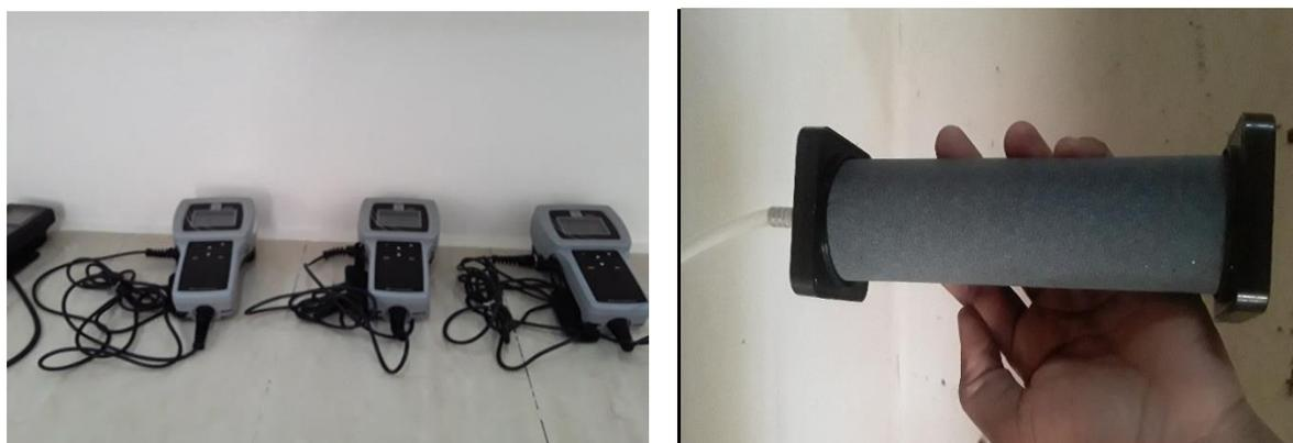
**Anexo12:** Instrumento usados para medir temperatura e oxigênio, modelo de pedra porosa usada para a aeração.
