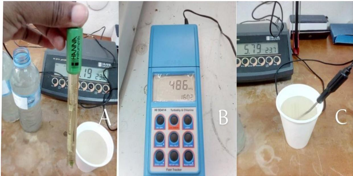
Figura 9:Processamento dos parâmetros (pH, turbidez e temperatura °C ) no canal.
