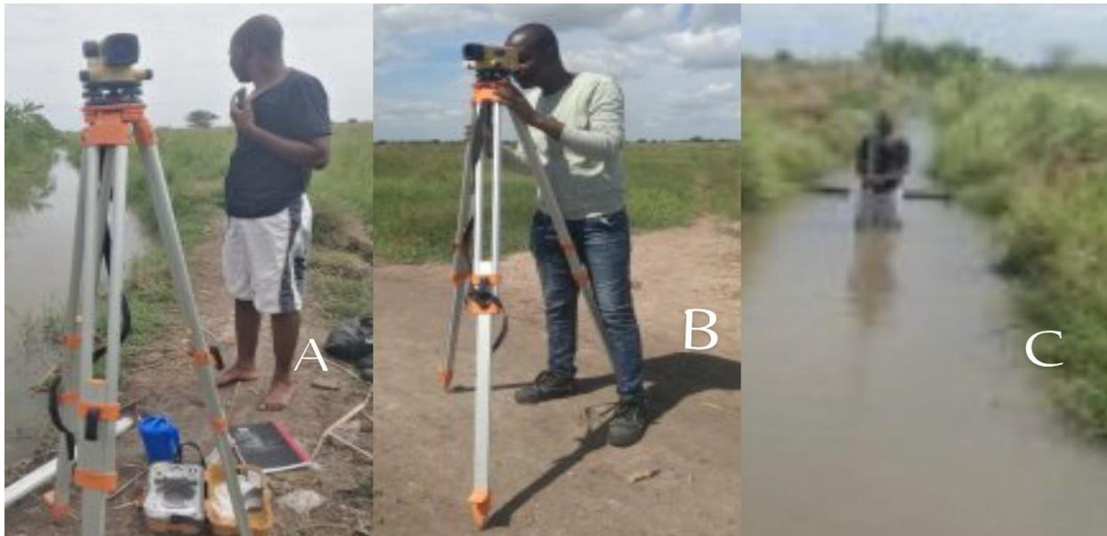
Figura 7: Levantamento topográfico usando nível no sistema de regadio de CEXP do ISPG.
