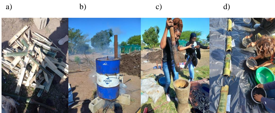
Figura 2: Preparação da matéria-prima: a) bambu em pedaços; b) carbonização do bambu; c) trituração do carvão do bambu; d) homogeneização dos finos do carvão de bambu.
