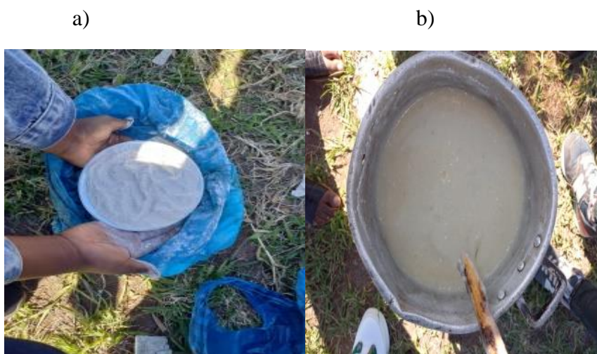
Figura 3: Confeção do aglutinante: a) mistura de fécula de mandioca e farinha de milho; b) aglutinante (pasta gelatinosa).
