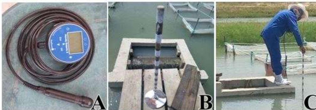
Figura 9: A. Oxímetro; B. Disco de Secch; C. Medição dos parâmetros de qualidade de água;
