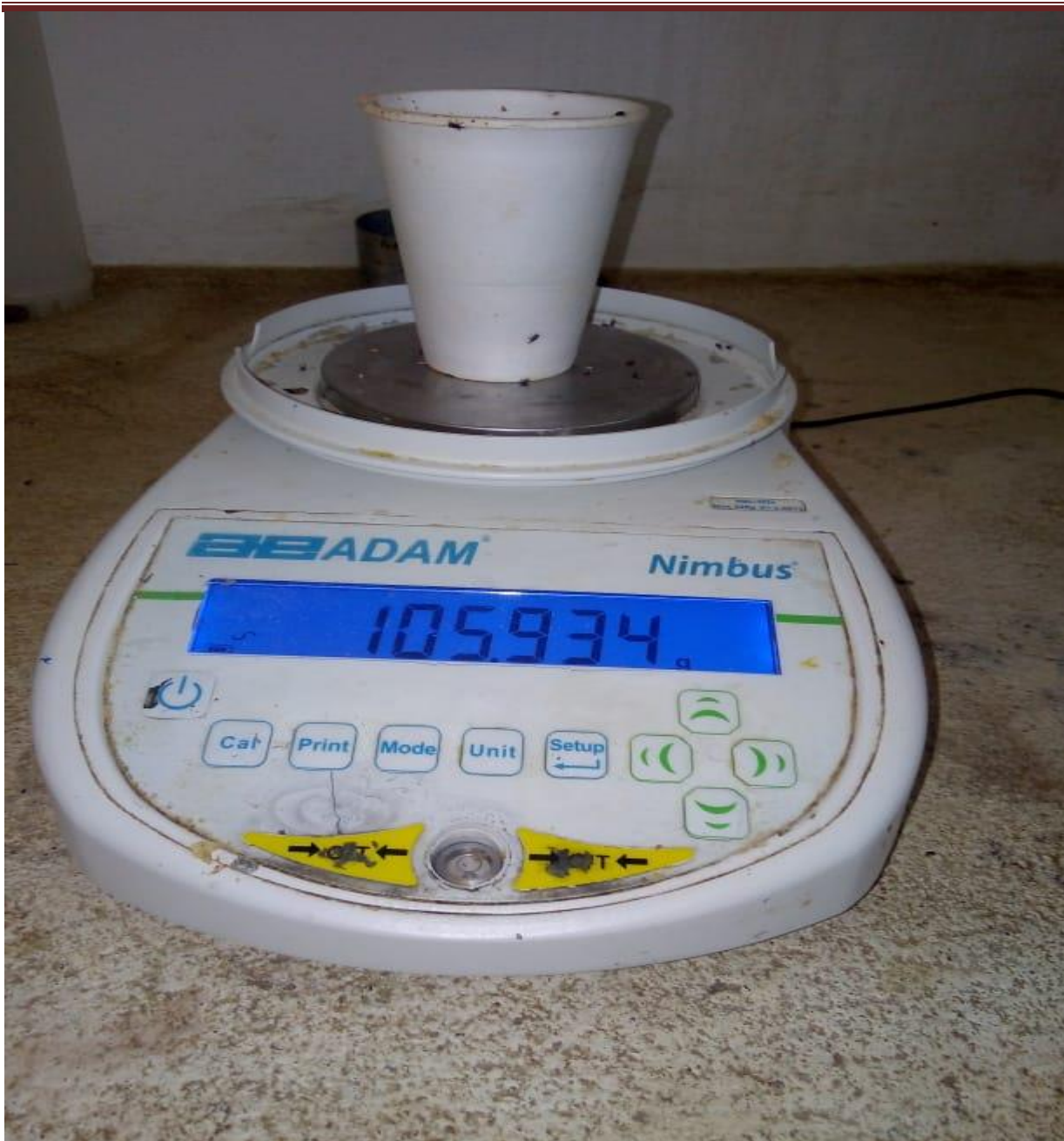
Figura 17: Ilustração da balança utilizada para determinar a perda de peso.
