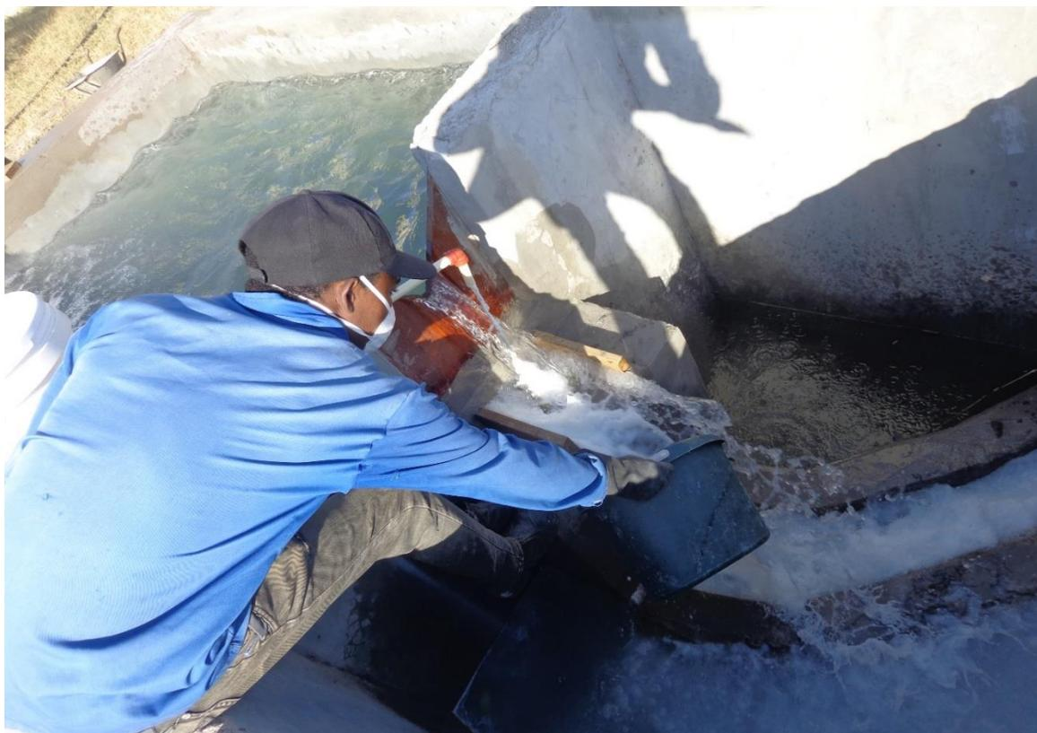
Figura 12: Colecta das amostras de calda após a mistura
