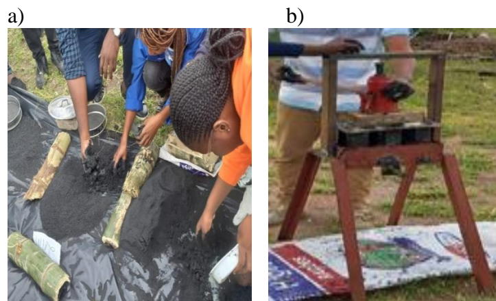
Figura 8- Produção dos briquetes, a)-Mistura da biomassa e o gel; b)- Produção dos briquetes em uma briquetadeira manual
