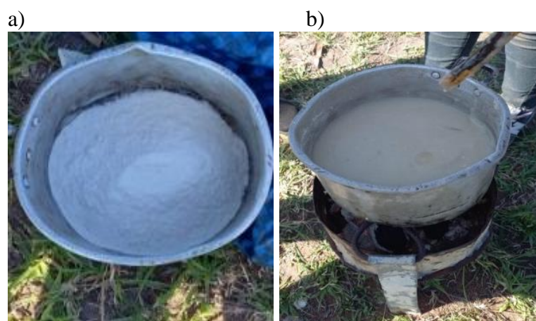
Figura 7. Produção do material ligante, a)- Adição da mistura e água; b)- Produção do gel
