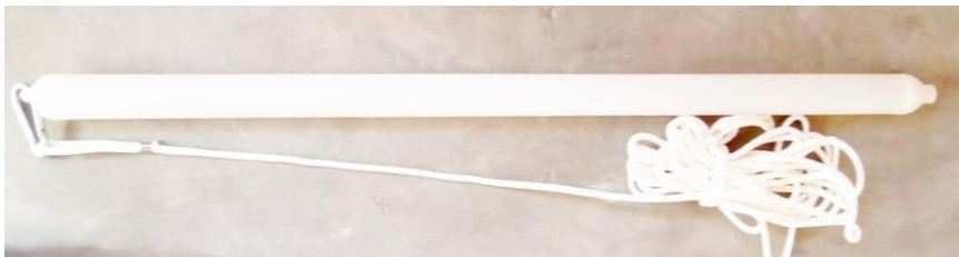
Figura 9. Bailer usado para a colecta de amostras de água subterrânea nos piezómetros.
