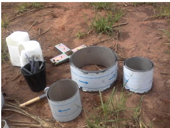
Figura 5: conjunto de anéis de infiltração
