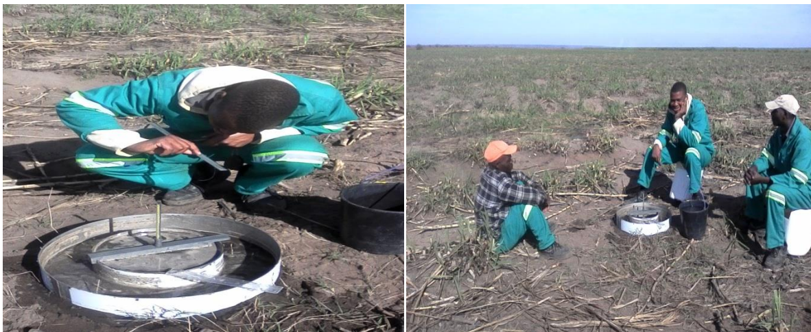
Figuras 6 e 6: Leitura da infiltração da água
