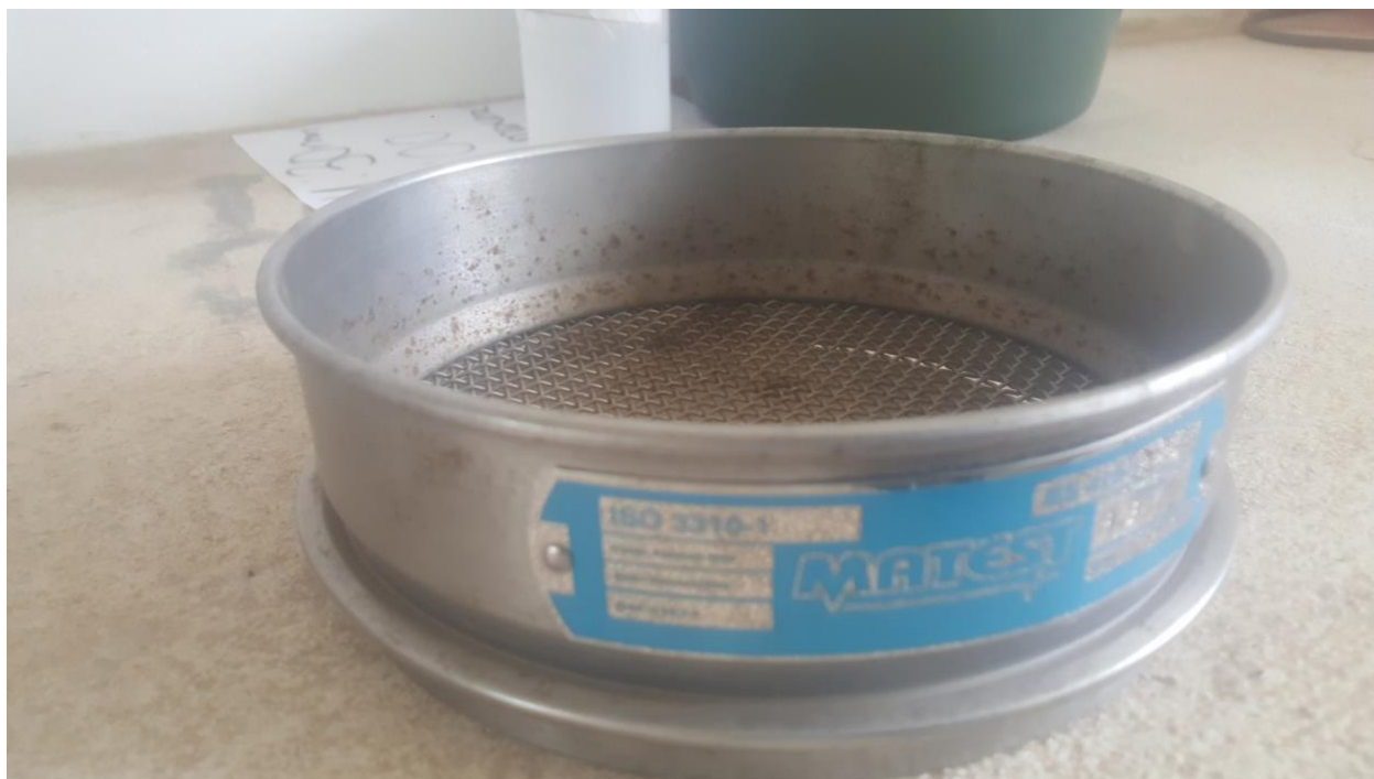
Figura 16: Malha utilizada para a separação de grãos quebrados para a conservação de milho. Fonte: Autor.
