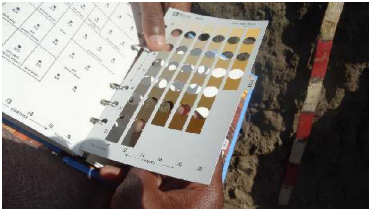
Figura 3. Manual de Munsell usado para a designação da cor da camada/horizonte.
