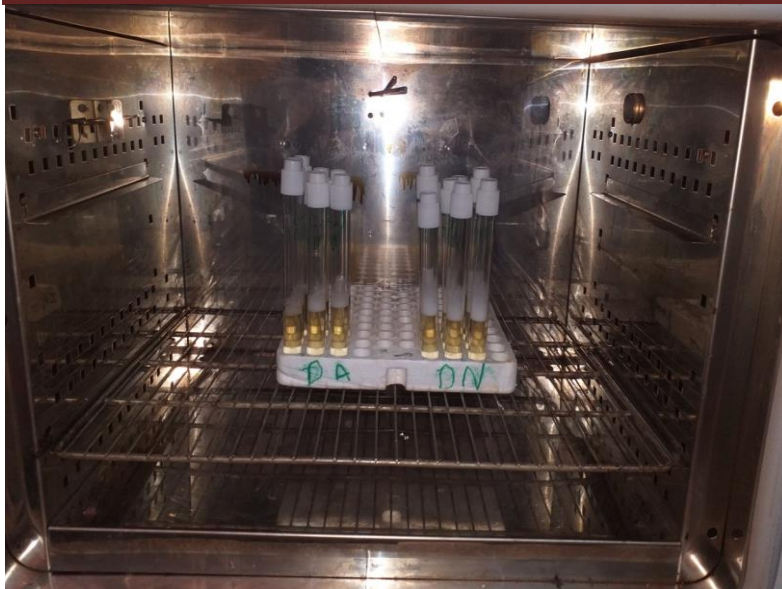
Apêndice 6. Tubos de ensaio contendo caldo LST, no teste presuntivo Fonte: Autor, 2021
