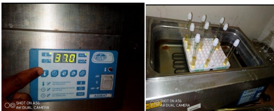
Apêndice 8. Tubos de ensaio confirmativos de CTT incubados em um banho-maria a 37oC por 48h. Fonte: Autor, 2021
