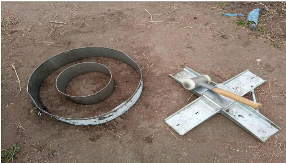
**Figura 2:** Infiltrômetro de duplo anel enterrado, cruzeta e martelo mecânico.
