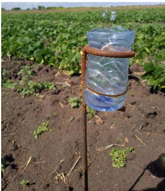
**Figura 5:** Coletor de água instalado no solo.
