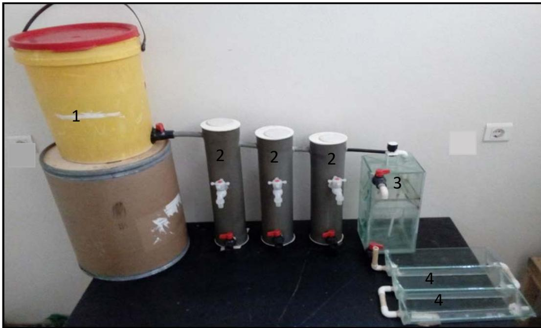
Figura 8: Vista geral do sistema de tratamento de esgoto sanitário na escala laboratorial ou de bancada
