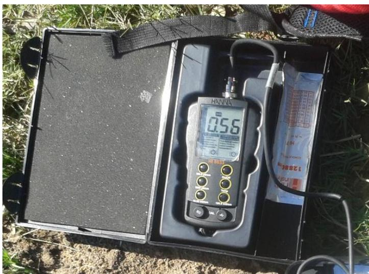
Figura 4: Condutivímetro usado para análise "in situ":
