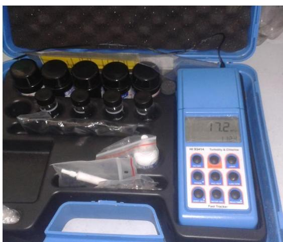
Figura 6: Turbidímetro
