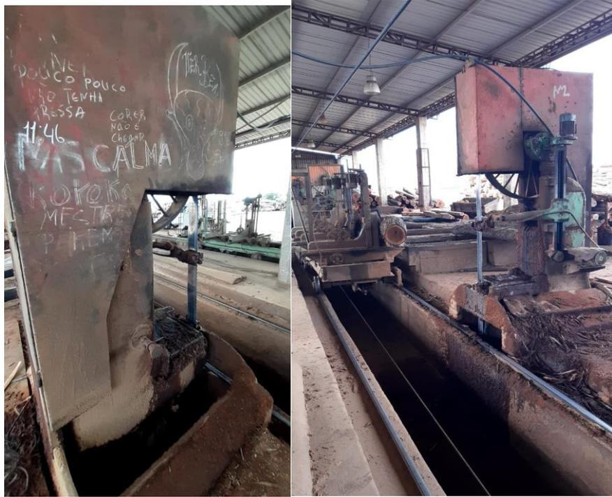
**Figura 7:** Serra fita vertical usada na serração da empresa Inchope- madeiras.
