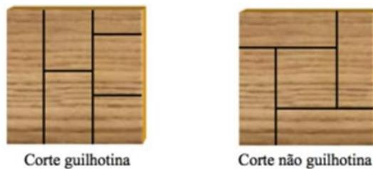
**Figura 2:** Ilustração simplificada dos tipos de cortes.
