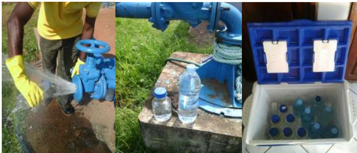
Figura 3.5: As figuras ilustram o processo de coleta de amostras de água no furo de água, os recipientes usados e o calmane com as amostras.
