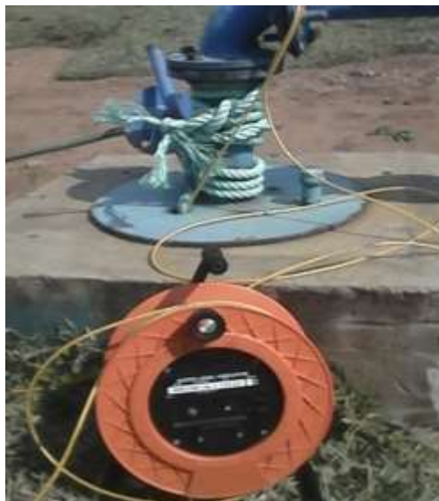
Figura 3.4: Medição de níveis hidrodinâmicos no furo com recurso a sonda eléctrica de 100m, marca BFK100.
