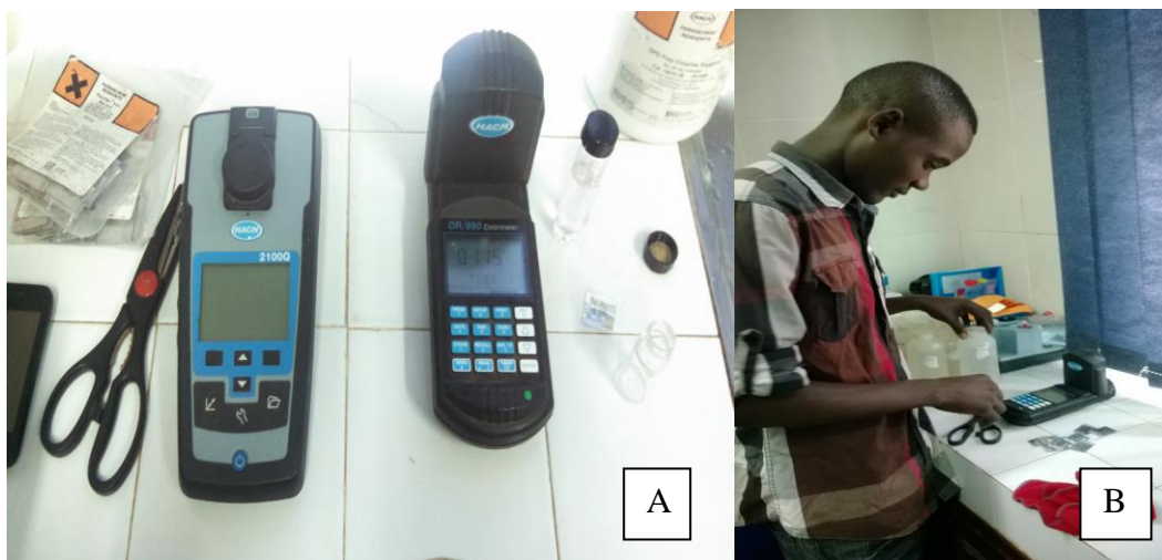
Figuras 6: Aparelhos Usados para Fazer as Análises de Turbidez, Cloro, Ferro, Nitrato e Manganês (A), e Avaliação do Nível de Cloro (B).
