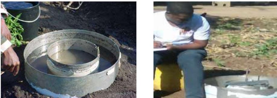
Figura 3.1: Teste de infiltração do solo medido no campo. Fonte: Autor
