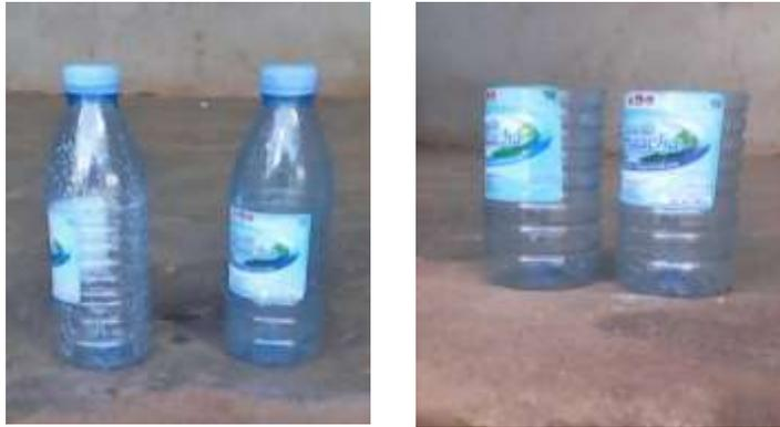
Figura 3.2: Figurino das garrafas plásticas (pluviómetros) usados. Fonte: Autor
