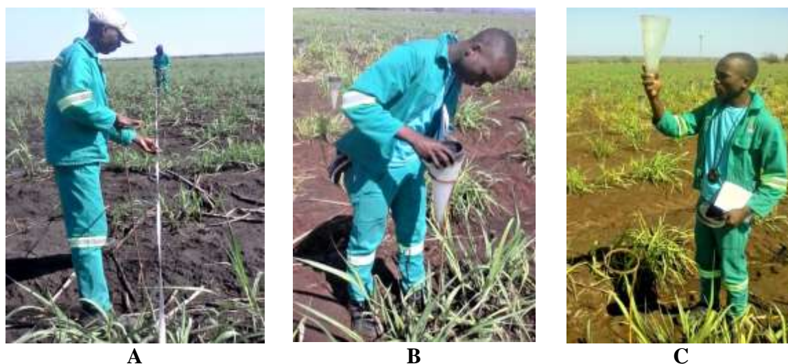
Figura 5. Processo de colecta de água precipitada pelos aspersores. Medição dos espaçamentos (A), montagem dos pluviómetros (B) e leitura da lâmina aplicada (C).
