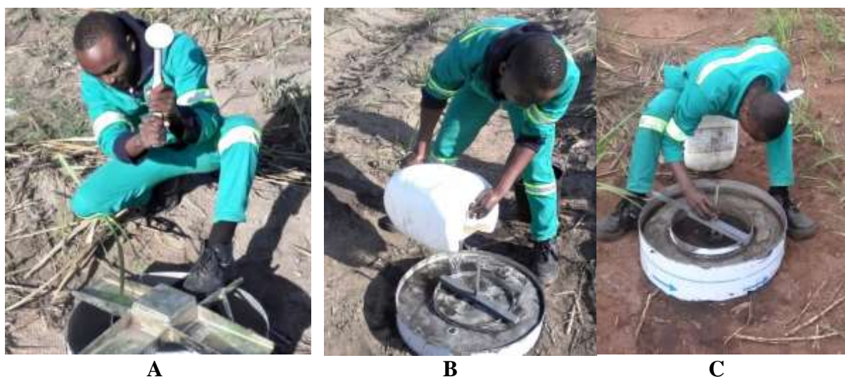
Figura 2. Medição da infiltração com infiltrómetro de anel duplo. Instalação do anel (A), introdução de água (B) e leitura da carga hidráulica (C).
