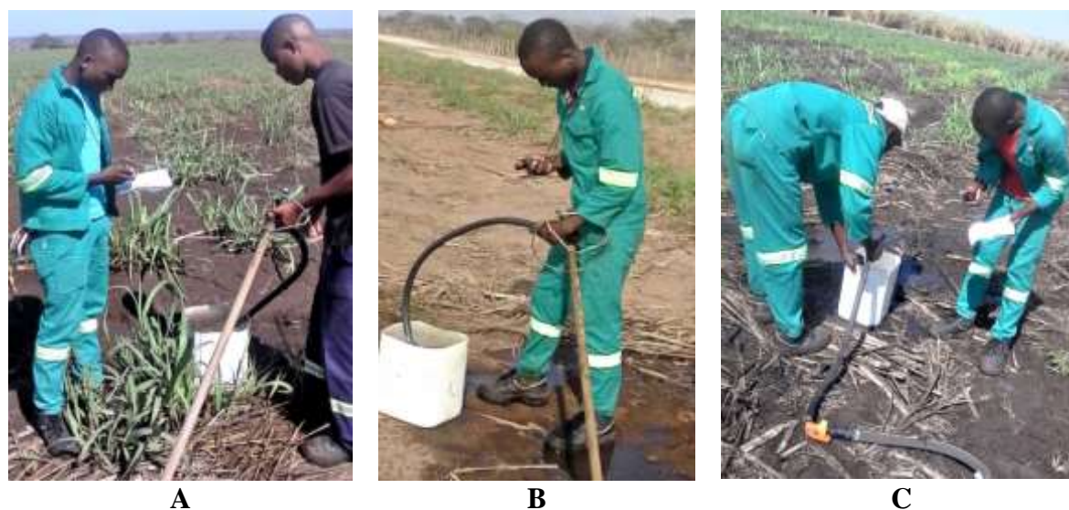
Figura 4. Processos de medição de caudais. Medição dos caudais nos aspersores (A e B) e medição do caudal nos hidrantes (C)
