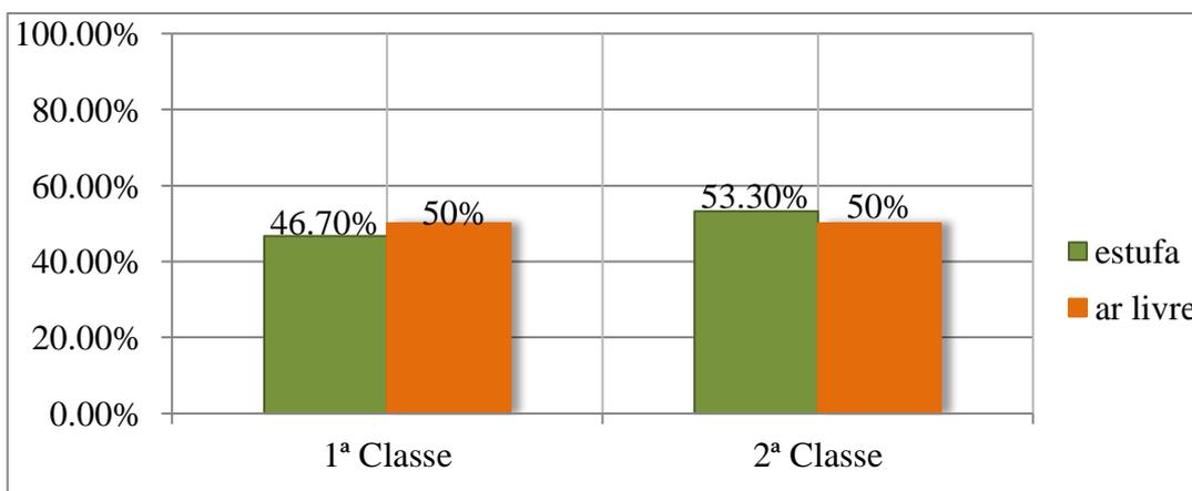
**Figura 11:** Classificação da madeira quanto a presença de rachaduras
