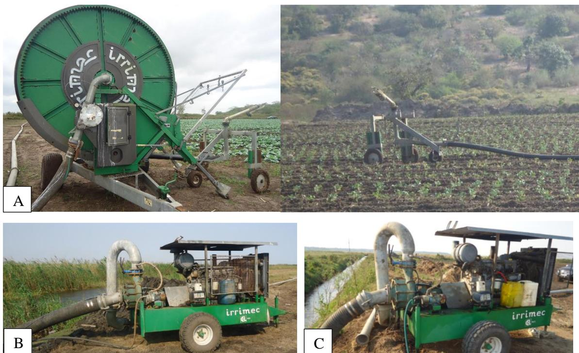
**Figura 3.2:** Conjunto canhão hidráulico e estações de bombagem, (A) Conjunto canhão hidráulico, (B) Primeira estação de bombagem, (C) Segunda estação de bombagem.
