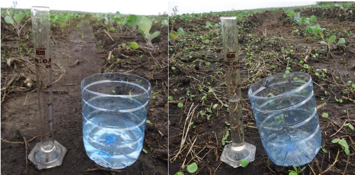
**Figura 3.5:** Leituras das lâminas coletadas com o auxílio de uma proveta graduada.
