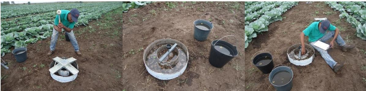
**Figura 3.7:** Medição da infiltração com infiltrômetro de anel duplo.
