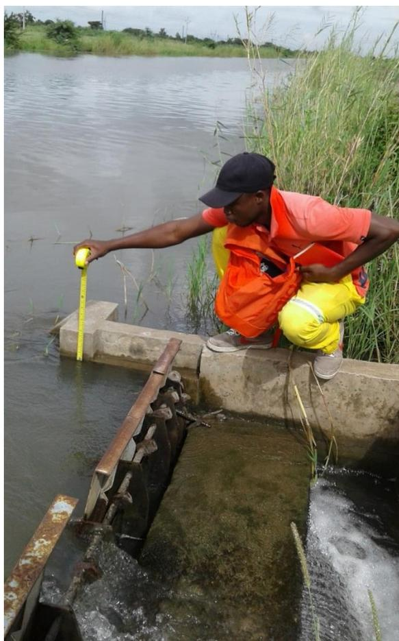
Figura 4: Medição de caudal de entrada nos módulos de mascara
