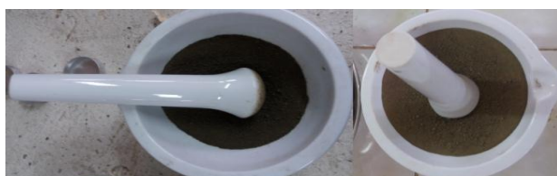
Figura 7: Destorroamento de solos. Fonte: autor (2019).
