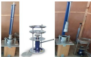
Figura 12: Material de compactação de solos. Fonte: autor (2019).
