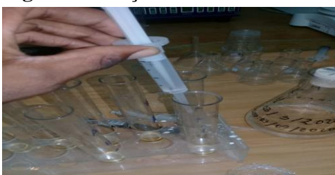
Figura 9: Adição Hidróxido sódico
