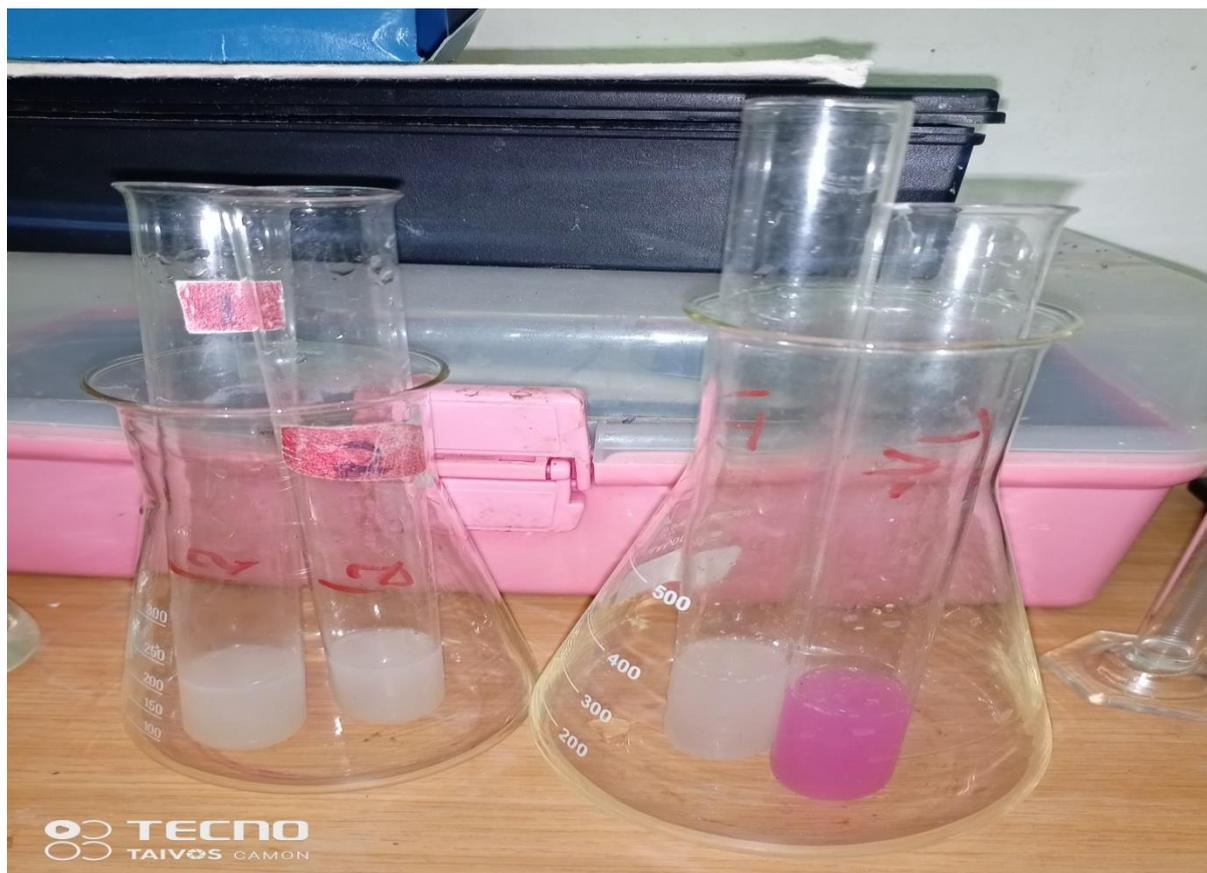
Figura 16: preparação de amostras para determinação de proteínas (formol)
