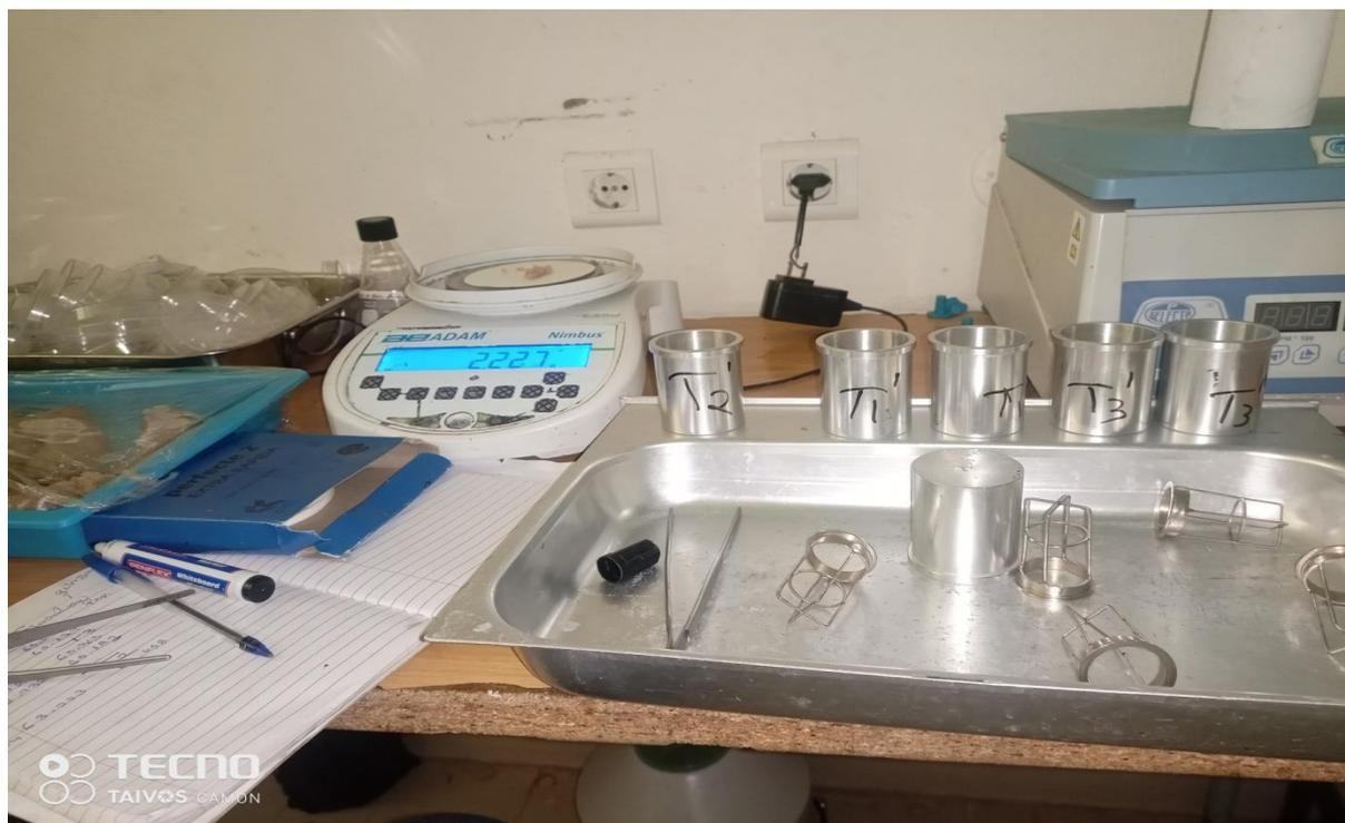
Figura 14: Preparação de amostras para determinação de gorduras
