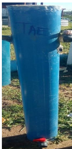
Figura 10: Representação do modelo do tanque de acidificação e equalização do dejetto de suíno.
