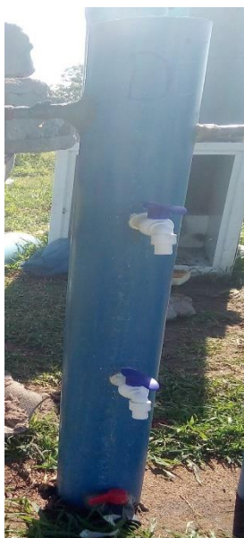
Figura 9: Modelo do decantador para a sedimentação do dejetos de suíno.
