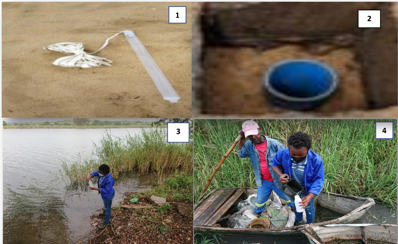
Figura 9: Procedimentos de coleta de dados no campo e o respetivo material. 1- bailer usado para coleta de amostra de água subterrânea; 2- furo de água; 3- coleta de amostra de água no rio; 4 - coleta de amostra de água na lagoa cocotiva.
