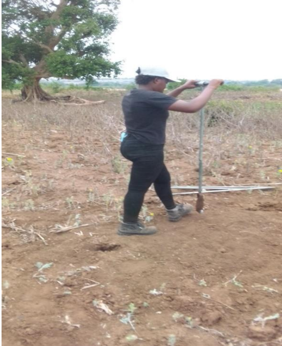
Figura 10: Ilustração do processo de coleta de amostra de solo na área de estudo. 1- Coleta de amostra de solo usando trado manual; 2- amostras de solo organizadas em profundidades.
