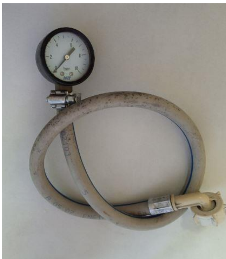
Figura 8: Manômetro de pressão de água (em bar).
