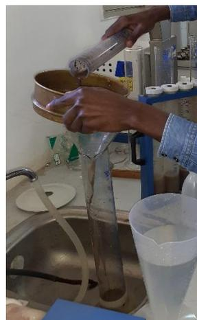
Figura 9: Separação da areia do conjunto silte e argila
