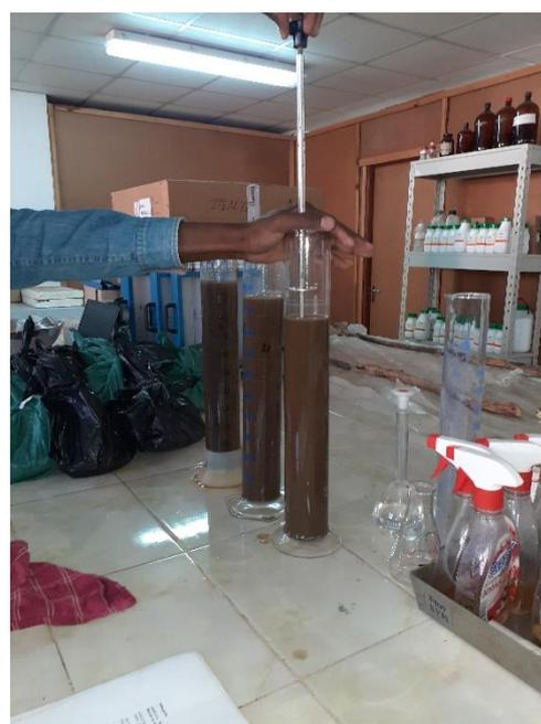
Figura 11: Agitação de amostra do solo
